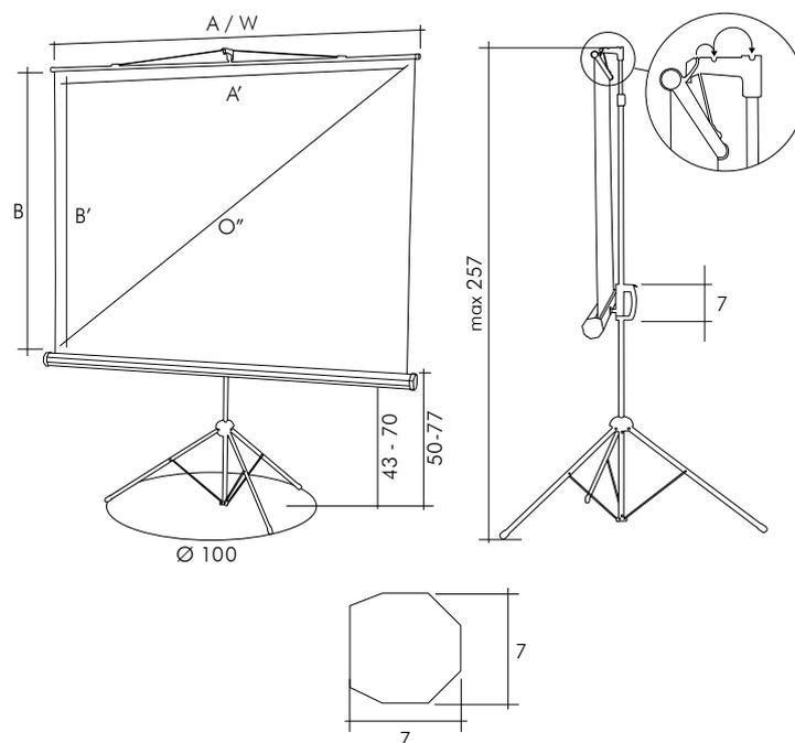
Sotto: sistema di inclinazione del telo di proiezione anti-keystone; maniglia con rilascio a scatto per alzare ed abbassare il telo
